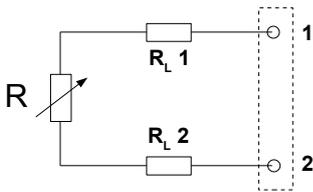
C'est la méthode la plus simple, mais les résistances de ligne (RL1 et RL2) sont en série avec l'élément sensible. L'erreur correspond à  $RL1 + RL2$ , d'où un décalage de la température mesurée et de la température réelle. C'est le montage à éviter.
