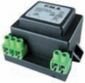
**KI - AL - 100 A** : Alimentation de Classe 2 pour capteur, montage par brides de fixation intégrées, tension d'entrée : 230 Vac, tension de sortie : 24Vac, intensité 100mA.
