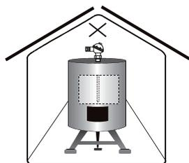
Sonde à tête montée verticalement dans la cuve avec tête de raccordement démontable
