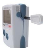
Après avoir emboîté votre KISTOCK sur la plaque de fixation, insérer le tube pour verrouiller le système de fixation.
