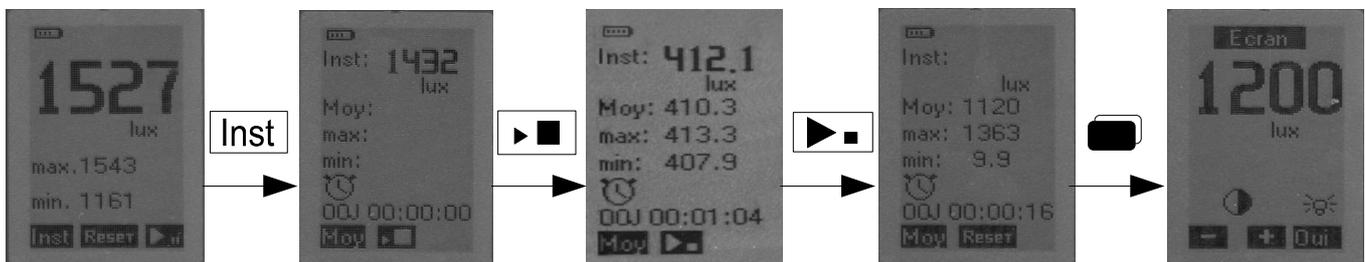
A partir de l'écran de démarrage, l'opérateur accède à la mesure Moy de l'éclairement sur une durée contrôlée par chronomètre, il procède comme suit :
