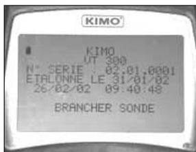
Pour accéder à un menu, brancher la sonde correspondante. Si celle-ci est munie du système SMART PRO, l'écran affiche le type de sonde insérée, et sa date d'étalonnage ou d'ajustage. Pour accéder au menu appuyer sur la molette. Pour revenir à la page d'accueil, débrancher la sonde.
