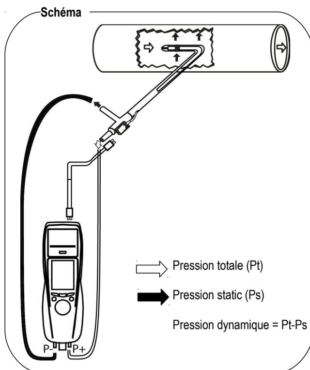
Le tube de Pitot doit être introduit perpendiculairement, au milieu de la conduite et face au flux à contrôler.
