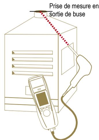
Placer la sonde du KIGAZ 100 dans le coupe-tirage, en passant par les ovies latérales de la chaudière.
