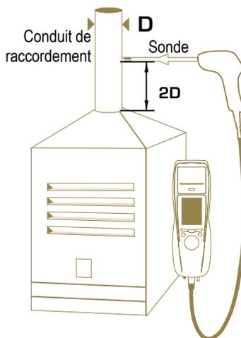
Placer la sonde du KIGAZ 100 dans la buse de sortie, au départ du conduit de raccordement.
