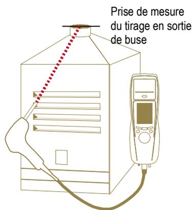
Placer la sonde du KIGAZ 100 dans le coupe-tirage, en passant par la face avant de la chaudière.
