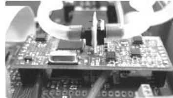
1 - Ouvrir le capteur. Le SPI se situe dans le volet gauche du capteur.
