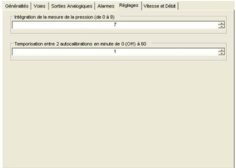
Pour régler la valeur de l'intégration, cliquer sur l'onglet "Réglages" et utiliser les flèches situées sur le côté droit du champ "Intégration de la mesure de la pression", ou saisir numériquement la valeur souhaitée (de 0 à 9).
