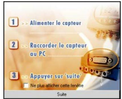
Il se peut que le message suivant apparaisse à l'écran. Cela signifie qu'il y a un problème de connexion entre le capteur et le PC. Il faut alors :
