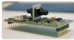
La carte SPI (Sonde de Pression Interchangeable) intègre un élément sensible de type piézorésistif ainsi que son électronique numérique. Ce système, ajusté individuellement, intègre tous les paramètres d'étalonnage. Automatiquement reconnue par le capteur cette carte numérique est totalement interchangeable. Elle facilite grandement la maintenance, le service et l'étalonnage des capteurs sans immobiliser l'ensemble de la chaîne de mesure lors d'interventions.
