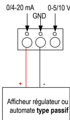
> Raccordement de la sortie tension 0-5/10 V :
