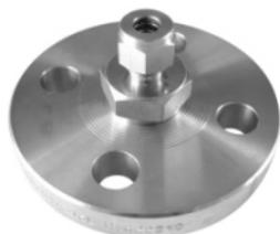
**KI-DIN/RCCT-13/12 13 790** : Bride filetée inox selon DIN 2566 avec raccord coulissant ½ gaz cylindrique avec olive téflon pour sondes Ø 13 mm.
